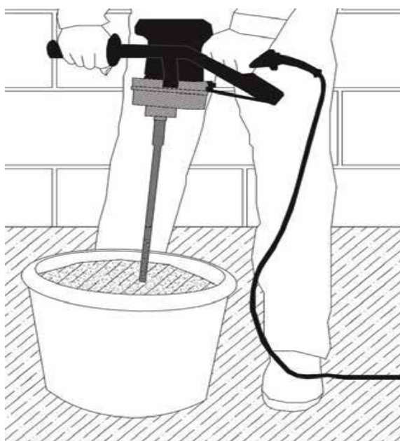
Рисунок 4.9.1 Приготування розчинової суміші за допомогою будівельного міксера
